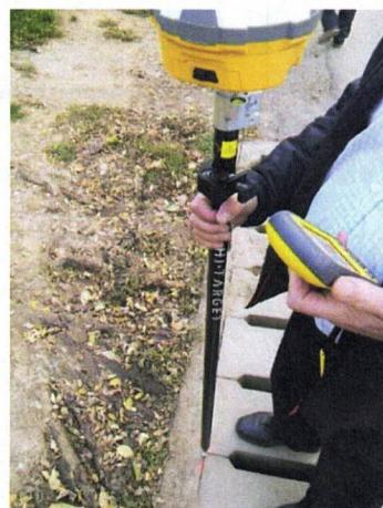
Foto 2.1.2.-5. Preluarea coordonatelor cu ajutorul GPS- ului geodezic,materializarea punctului cunoscut cu buloane și vopsea
