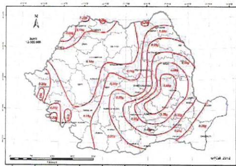
Figura 3.1 România - Zonarea valoarelor de vârf ale accelerării terenului pentru proiectare  $a_g$  cu IMR = 225 ani și 20% probabilitate de depășire în 50 de ani
